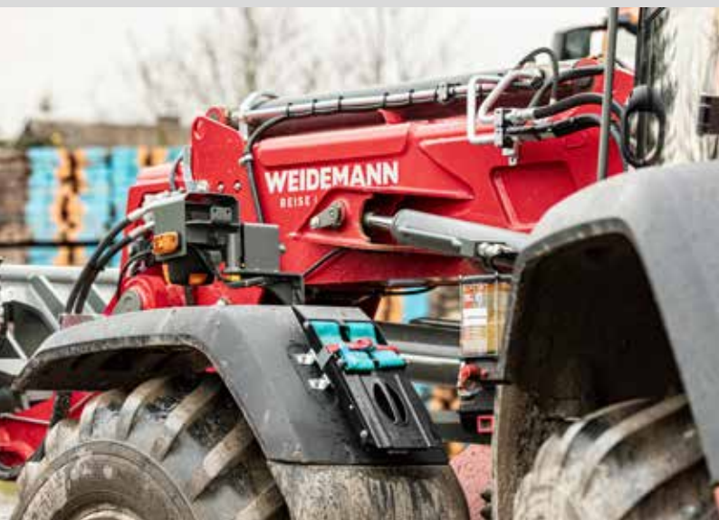
Die Zentralschmieranlage versorgt alle beweglichen Bauteile.
